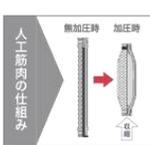
①高反発ゴムによる脇から大腿部のアシストラインと②独自開発の空気圧式人工筋肉が中腰姿勢維持をアシスト。専用ポンプで5回程度ポンピングし、空気を供給するだけで、人工筋肉が人間の筋肉のように収縮し、中腰姿勢のキープをラクにします。
