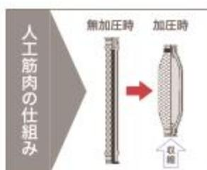
①高反発ゴムによる脇から大腿部のアシストラインと②独自開発の空気圧式人工筋肉が中腰姿勢維持をアシスト。専用ポンプで5回程度ポンピングし、空気を供給するだけで、人工筋肉が人間の筋肉のように収縮し、中腰姿勢のキープをラクにします。
