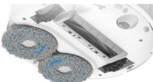
自動ゴミ収集システムには、当社独自のデュアルブースト2.0システムが採用されており、本体の空気を強く吹き込み、ステーションの紙パックへと高速で吸い込みます。騒音を最低限に抑えてゴミを収集し、目詰まりはほとんど起こりません。
